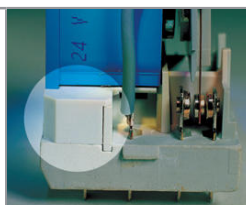
B: Rodzaj zestyku 5, 6 Dodatkowa izolacja pomiędzy cewką a stykami (do aplikacji SELV)
